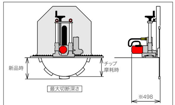
※寸法はダクトホース組をはずした時で、ブレードは「二条切用ブレード」を使用します。
