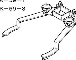
水処理パッドを固定する金具です。ポールベースに取り付けて使用します。
