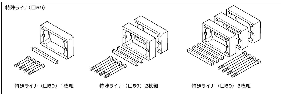
12"～16"のコアビットで水処理パッドを使用する時に、ギヤドモータと□59クランプ組の間に取付けて使用します。
