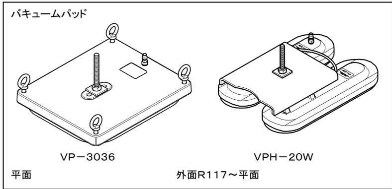
バキュームパッドを吸着させる時に用います。アンカー施工できない場所に、ポールベースを簡易に吸着固定することができます。
