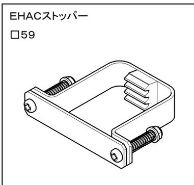
ポールベースに取付け、ドリルヘッドの送りを希望位置で止めることで、穴あけ深さを設定できます。
