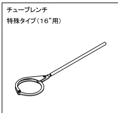
16"のビット・チューブ・カップリングの取付け、取りはずしに用いる専用工具です。
