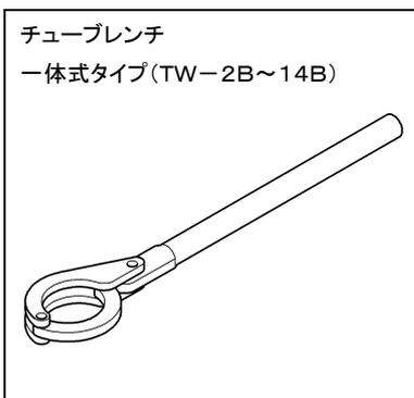
ビット・チューブ・カップリングの取付け、取りはずしに用いる専用工具です。
