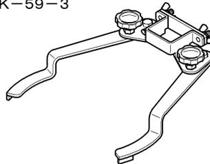
水処理パッドを固定する金具です。ポールベースに取付けて使用します。
