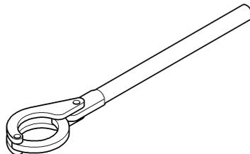
ビット・チューブ・カップリングの取付け、取りはずしに用いる専用工具です。
