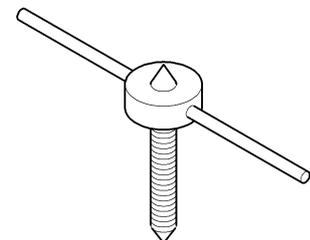
アンカーを施さずに、ジャッキ固定する時に使用します。
