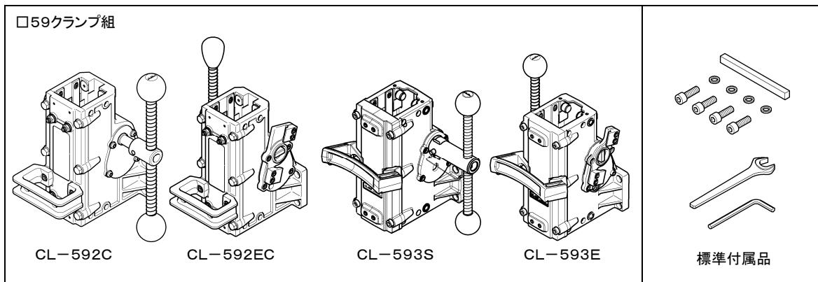
金属製スライドプレートを組込んだ□59クランプ組で、SPX・SPE・SPO・SPMシリーズのギヤドモータに取付けて使用します。CL-592EC、CL-593EはE仕様の自動送り装置を取り付けることができます。また、CL-593SはS仕様の自動送り装置を左右どちら側にも取付けることができます。
