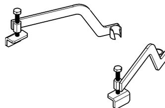
レベルボルトに取付けて使用する水処理押さえ金具です。水処理パッドMS-12~MS-14の取付けができます。
