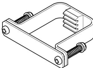
ポールベースに取付け、ドリルヘッドの送りを希望位置で止めることで、穴あけ深さを設定できます。
