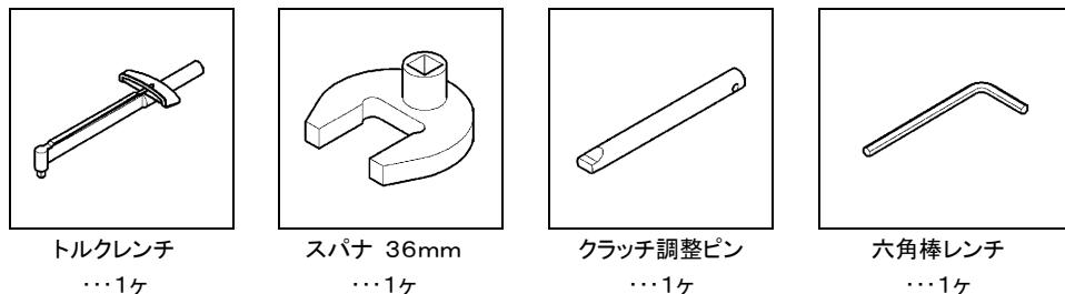
◎ 摩擦板の摩耗によりクラッチが滑りやすくなりましたら、クラッチ調整工具を使用して、再調整してください。
