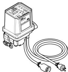
自動送りで穴あげができます。鉄筋を切断しない機能も搭載しています。S仕様は、クランプ部の左右どちら側にも取付けることができます。
