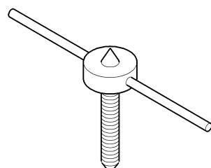
アンカーを施さずに、ジャッキ固定する
