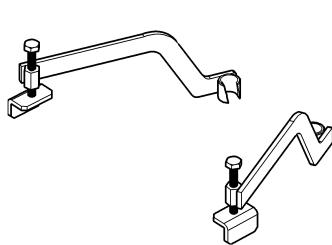
レベルボルトに取付けて使用する水処理押さえ金具です。水処理パッドMS-12～MS-14の取付けができます。
