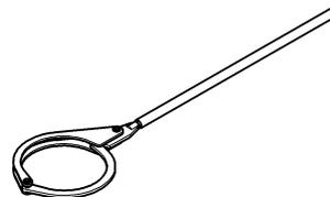
16"のビット・チューブ・カップリングの取付け、取りはずしに用いる専用工具です。
