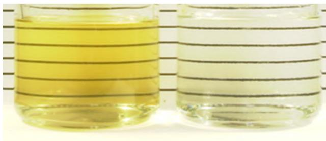
生分解性作動油(左)、一般鉱物油(右)
