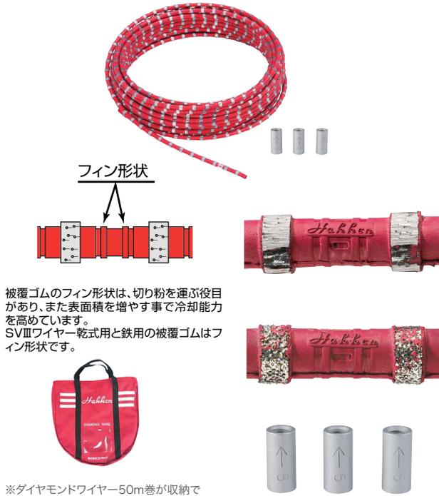
被覆ゴムのフィン形状は、切り粉を運ぶ役目があり、また表面積を増やす事で冷却能力を高めています。SVⅢワイヤー乾式用と鉄用の被覆ゴムはフィン形状です。
